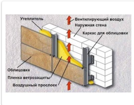
Вентилируемый фасад (навесной вентфасад) – это уникальная конструкция облицовки здания, которая крепится к несущей наружной стене сооружения с помощью профилей и специальных болтов. Сама конструкция вентилируемого фасада состоит из нескольких слоев, между которыми предусмотрено небольшое воздушное пространство
