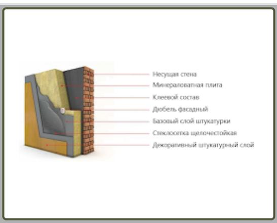
Тяжелые штукатурные системы состоят из последовательно нанесенных друг на друга слоев утеплителя, арматурной сетки и штукатурных растворов. При этом толщина штукатурных слоев после слоя теплоизоляции, в отличие от легких штукатурных систем, может достигать 50 мм
